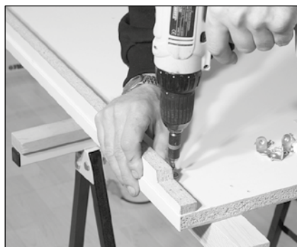
Het vulstuk wordt op het paneel gemonteerd met behulp van enkele stalen stoelhoeken (niet inbegrepen).
